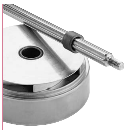
Рис. 5 Каждый второй шлиц вала используется как канал для возвращения жидкости обратно вниз, причем одновременно происходит и охлаждение подшипников.
